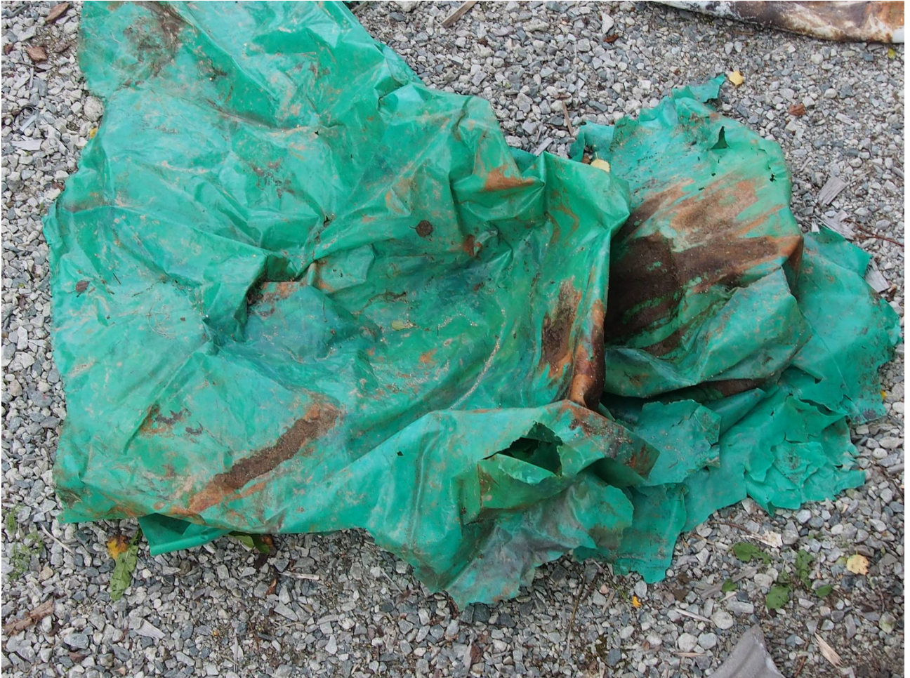
Bild 12. Fragment av byggplast.
